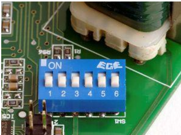
Afb. 6.8 Instellen toerental ventilator afzuigunit via dipswitches
