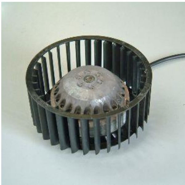
Afb. 7.7 Waaier na ultrasoon reinigen
