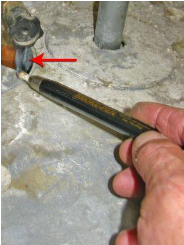
Afb. 6.6 Rookpen voor het detecteren van luchtlekkage of stromingsrichting
