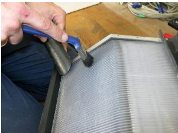
Afb. 7.4 Controle en reinigen lamellen warmtewisselaar
