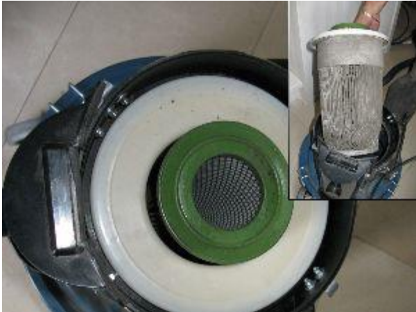
Afb. 7.3 Stofzuiger met HEPA-filter bij reiniging in de woning
