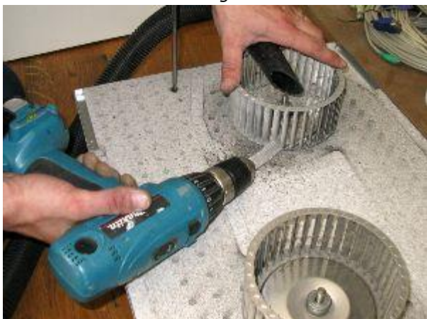
Afb. 7.5 Schoon borstelen waaiers ventilatoren
